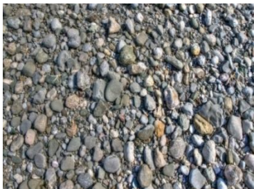
1. Gravier tout-venant non concassé
