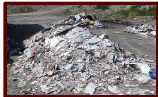
Les rebuts de démolition de cloisons sèches, de béton et de plastique ne sont pas acceptables pour le remblayage.
